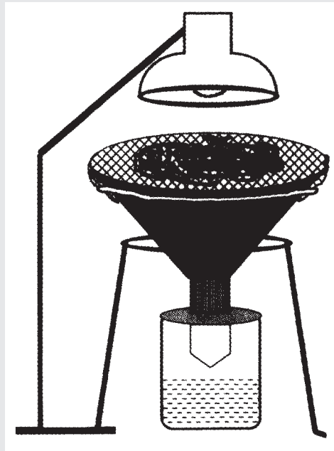
Foto: Opstelling om zelf springstaarten en mijten te meten (Natuurlijk in Balans, 2002)
